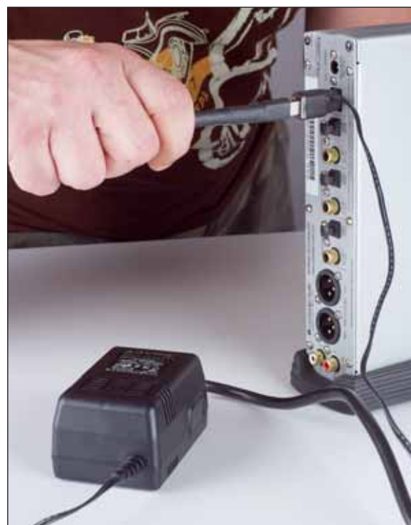
Das Low-Noise-Netzteil von Aqvox stellt die 5-Volt-Betriebsspannung bereit, die der USB-Controller benötigt. Allerdings arbeitet es viel sauberer als Beipackware
